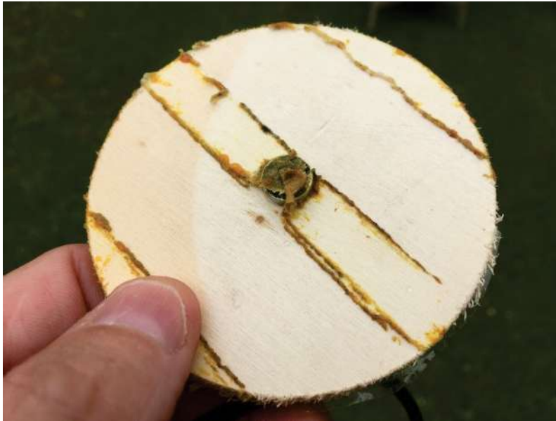
Abb. 7-1: Elektret-Mikrofone, ohne Filz und mit Propolis gefüllt. Bienen zerfressen den Filz auf Elektret-Messmikrofonen. Das kleine Loch in der Metallkappe wird mit Propolis verfüllt. Die Stockluft sorgt für eine rapide Alterung des Mikrofons. Nach vier Monaten im Stock ist ein Elektret-Mikrofon ohne Funktion.
