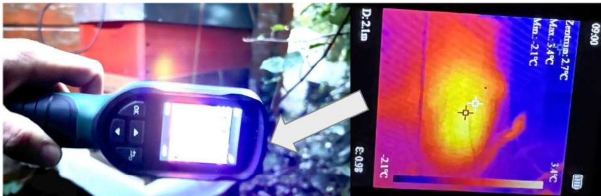
Abb. 6-6: Thermografie-Aufnahme der Beute von der Seite. Es ist die Aufnahmesituation und das Display aus der Nähe gezeigt. Zu sehen ist der helle Fleck in der unteren Zarge nahe des Fluglochs. Dort sitzen die Bienen in der Wintertraube.
